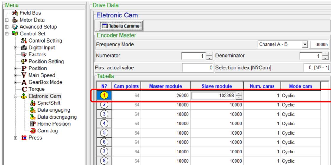
6. (a) 進入 Electronic CAM 的選項畫面, 輸入 **CAM points = 100**, 表示 Master motor 用 100 個位置表示 100mm, 方便. 可以解釋為 Master 0~100mm 的位置.
