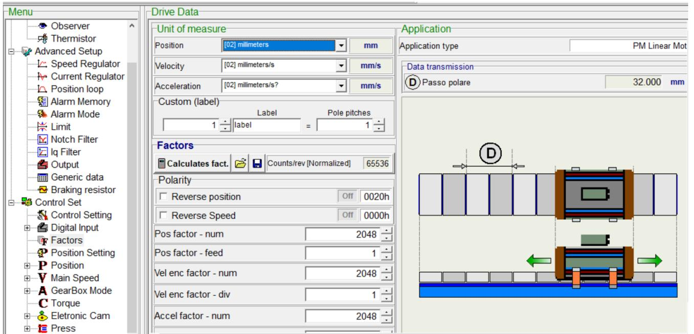
位置單位為 mm 設定流程, 按下 Calculate 後, 最後的 Pos factor 如上所示.
