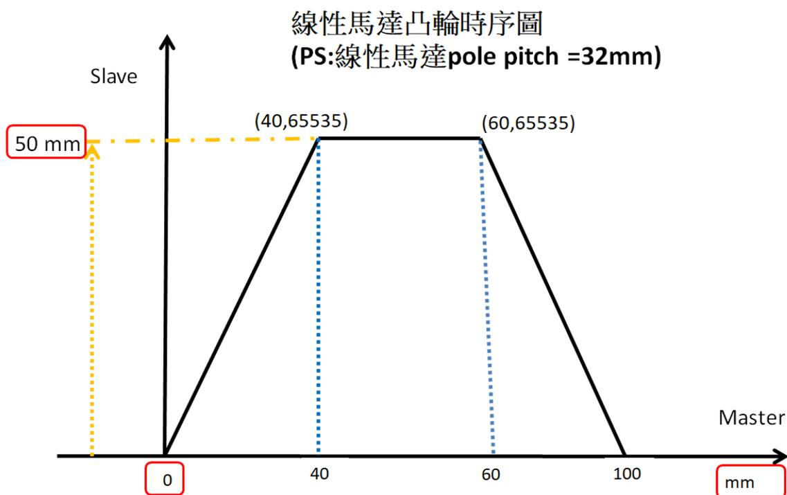
因為 **8000 pulse = 32mm**, 由凸輪時序凸得知 Master 走 100mm 為一個 cycle, Master module =  $8000 \times (100/32) = 25,000$  pulse.
