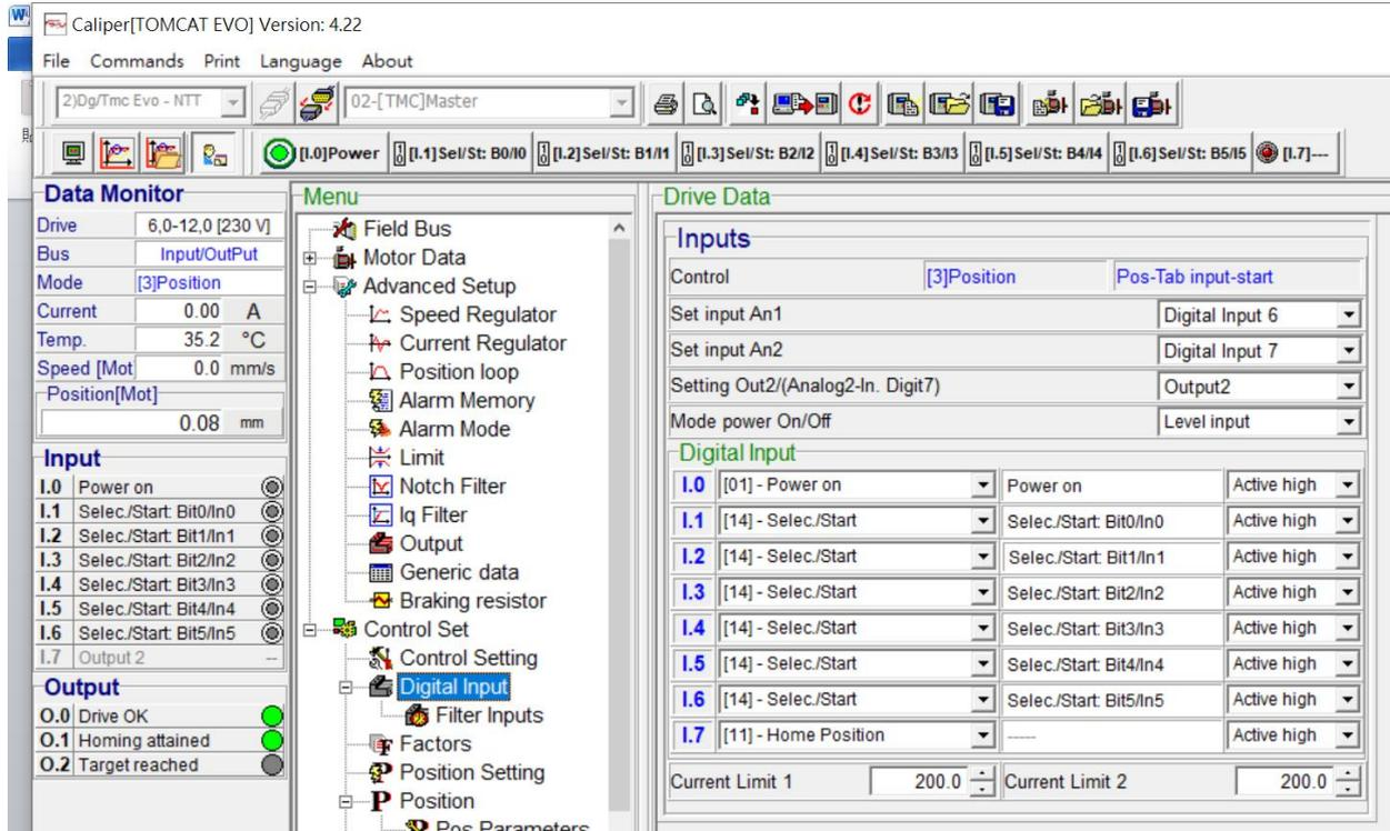
3. 在 Position 模式, 選擇 Pos-Tab input-start, 可以看到 6 個 Index 被點亮可執行, 如下圖所示
