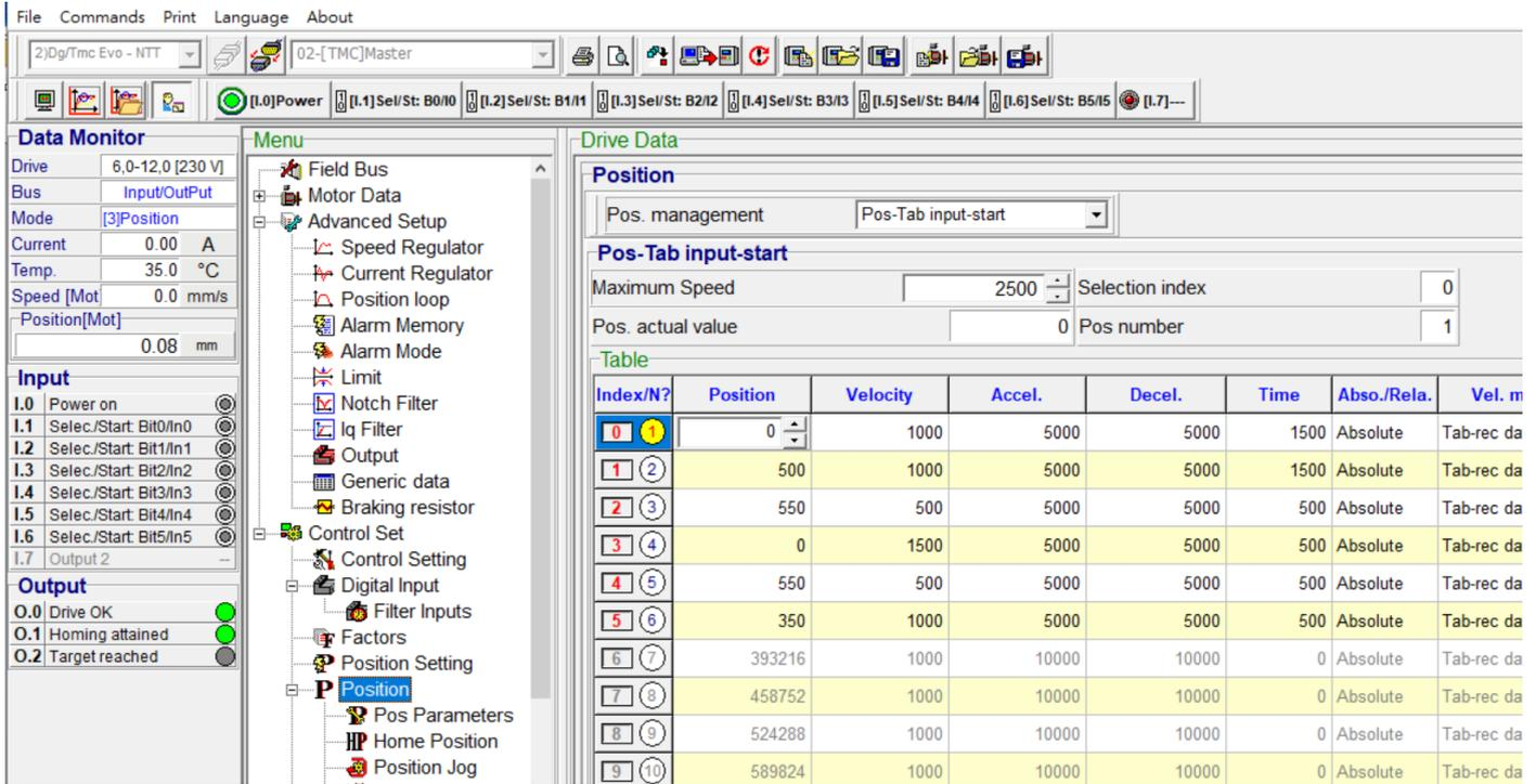
4. 在位置表中的 Setting pos. 選項中, 可以選擇 Blend next pos., 則可以做 2 個位置的移動, 最後停在第 2 個位置. 如下圖所示.
